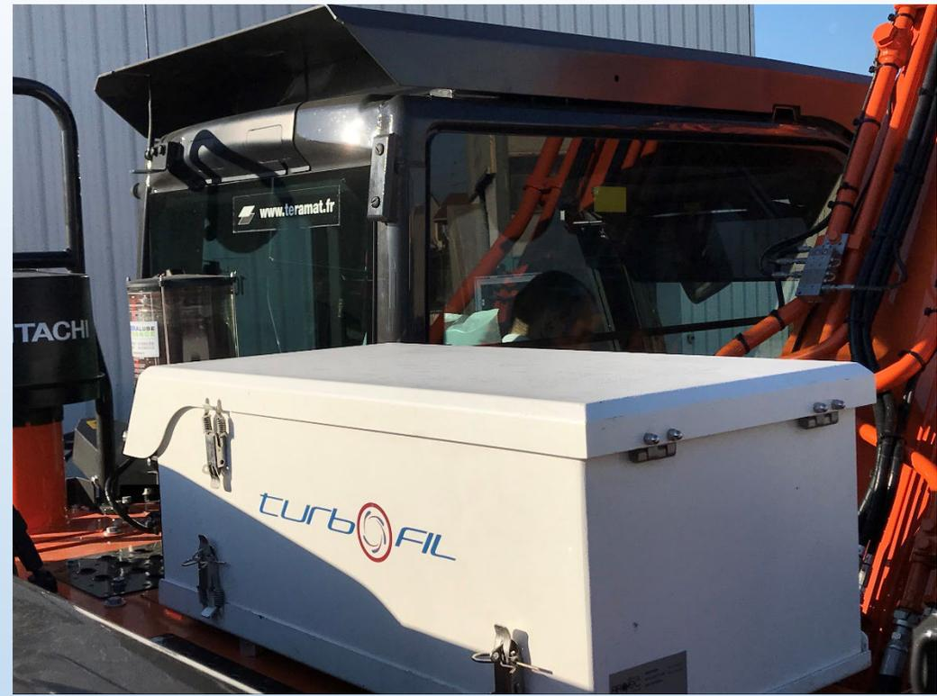
1 pelle mécanique sur chenilles HITACHI ZX210LC-6 de 22 Tonnes n° série 801896 mise en service 01/2020. Filtration cabine BROTEC pour tri et terrassement en zone polluée
