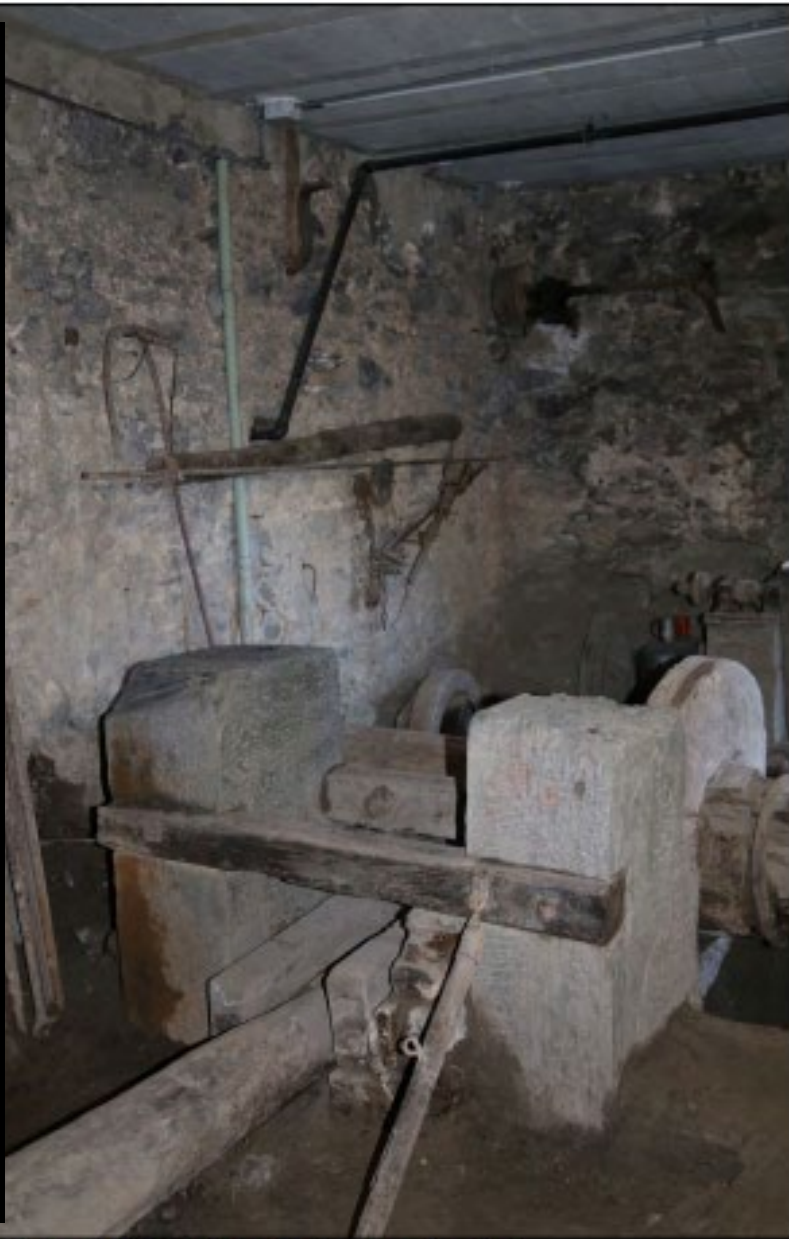
Martinet de la forge actionné par la roue en métal
